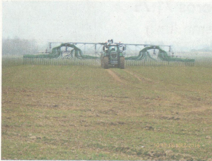
Düngemaschine mit ca. 29 Tonnen Fassungsvermögen
